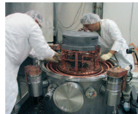
Le détecteur EDELWEISS en construction / Mounting of EDELWEISS
